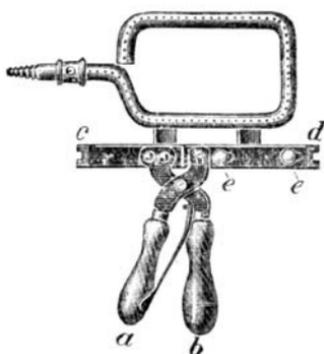
und links verschiebbar ist. Die zweite Schiene ist mit dem Handgriff *a*, die erste mit dem Griff *b* verbunden, so dass der Druck einer zwischen beiden Griffen befindlichen Feder die Führungen bei *c* und *d* auseinanderschiebt und an die Füße des Trockenschrankes anpresst. Dadurch ist die Heizschlange ganz fest eingestellt, ein Druck auf die
